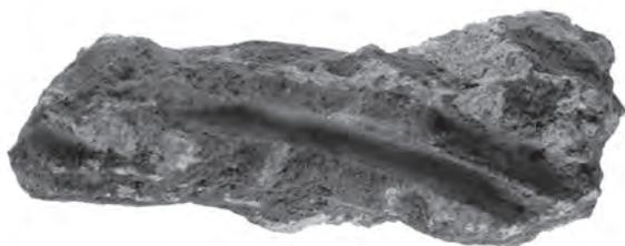
Abb. 16. Pohansko bei Břeclav. Zweite Kirche (nordöstliche Vorburg). Mörtelfragmente der Baukonstruktion mit Abdrücken kreisförmig gebogenen Flechtwerks.
