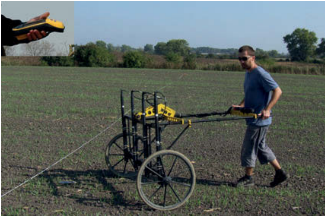
Obr. 84 Geofyzikálna prospekcia použitím magnetometra Foester Ferex (P. Milo) a zameranie plochy GPS prijímačom Trimble GoeExplorer 6000 (foto: M. Hladík, 2011)
